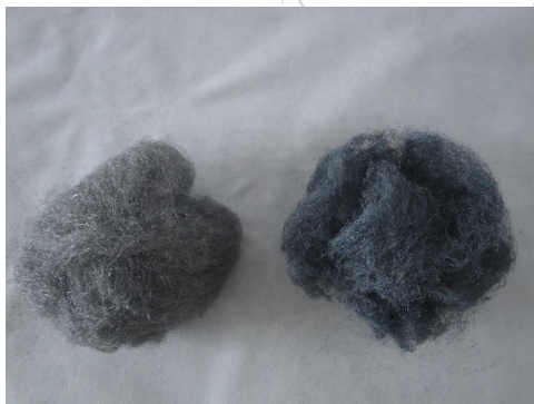
Figura 4. Lana de acero antes y después de la combustión. Diferencia en el aspecto de la lana de acero antes y después de la combustión. Fuente: El autor.
