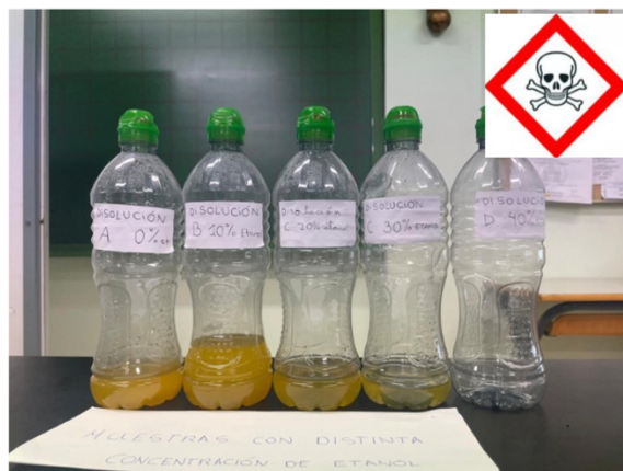
Figura 1. Disoluciones patrón utilizadas en la determinación de la cantidad de etanol. Fuente: Elaboración propia.
