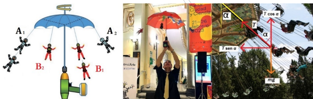
Figura 4. a. Montaje. b. Demostración en ConCienciaArte (Círculo de Bellas Artes, Madrid). c. Fuerzas que actúan sobre los cuerpos al girar en las sillas de un carrusel. Fuente: El autor.
