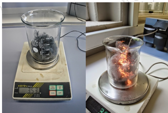
Figura 3. Desarrollo de la combustión. En el ejemplo de la figura, los cables de cobre están directamente conectados a una toma de corriente continua. Es más aconsejable, por seguridad y comodidad, utilizar el sistema propuesto en la figura 1. Fuente: El autor
