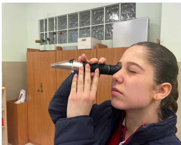
Figura 2. Medida de la graduación alcohólica con el refractómetro. Fuente: Elaboración propia.
