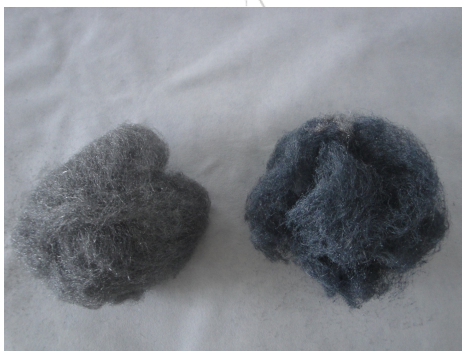
Figura 4. Lana de acero antes y después de la combustión. Diferencia en el aspecto de la lana de acero antes y después de la combustión. Fuente: El autor.
