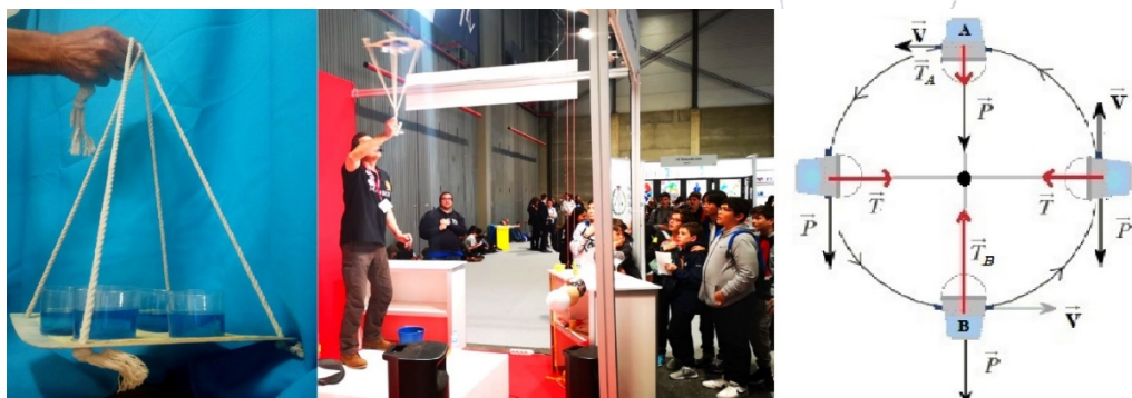
Figura 6. a. Bandeja con vasos de agua coloreada. b. Demostración en el stand de la RSEF durante la XII edición de la feria Madrid es Ciencia . c. Diagrama de fuerzas. Fuente: El autor.
