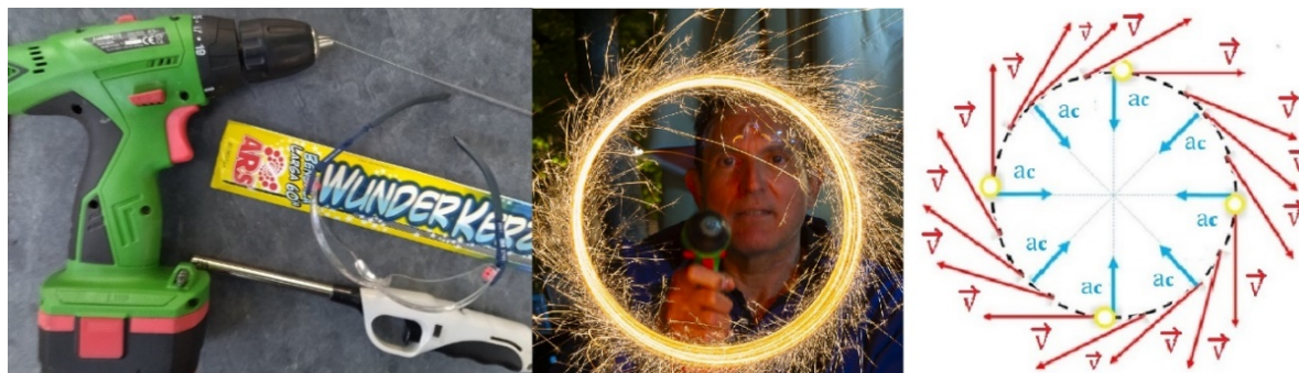
Figura 2. a. Material. b. Fotografía de larga exposición de la bengala girando. c. Representación de la dirección de la velocidad y de la aceleración centrípeta. Fuente: El autor.
