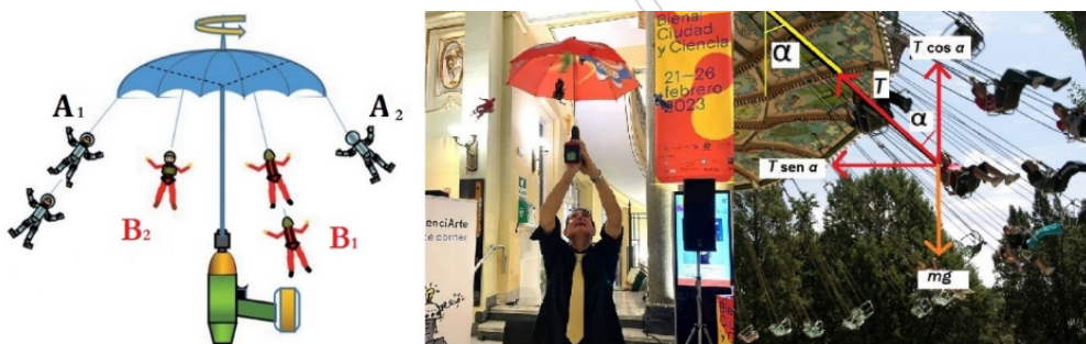
Figura 4. a. Montaje. b. Demostración en ConCienciArte (Círculo de Bellas Artes, Madrid). c. Fuerzas que actúan sobre los cuerpos al girar en las sillas de un carrusel. Fuente: El autor.
