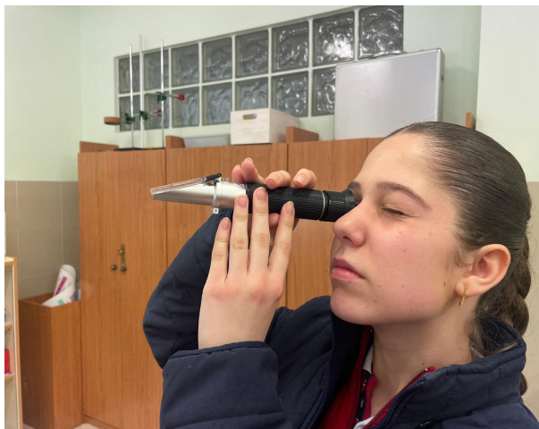
Figura 2. Medida de la graduación alcohólica con el refractómetro. Fuente: Elaboración propia.
