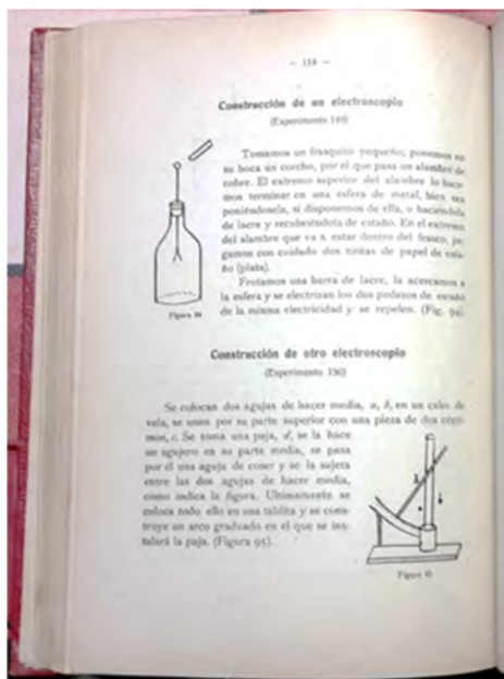
Fig. 3: Experimento 149 del libro Experimentos de Física . Construcción de un electroscopio.
