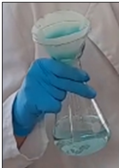
Imagen 5. Observación de la disolución azulada en el caso 2, que confirma que el reactivo en exceso es el sulfato de cobre (II).
