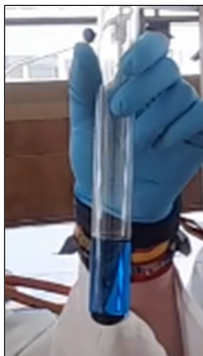
Imagen 7. Observación de la formación del complejo entre el ion \text{Cu}^{2+} y el amoníaco en el caso 1 (pasado el tiempo el color azul es más intenso).
